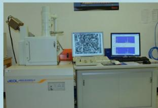
Fig. 7: Microscope électronique à balayage
